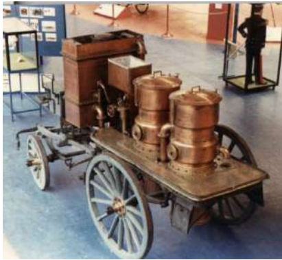
Uno de los primeros prototipos de vehículo autopropulsado de hidrógeno, con un motor mecanizado de cobre
